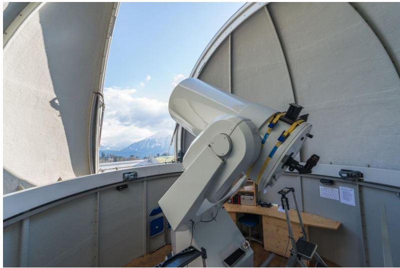
Bild: Teleskop: Ritchey-Crétien (zwei hyperbolische Spiegel), Durchmesser Hauptspiegel 637 mm, Brennweite: 5'000 mm
